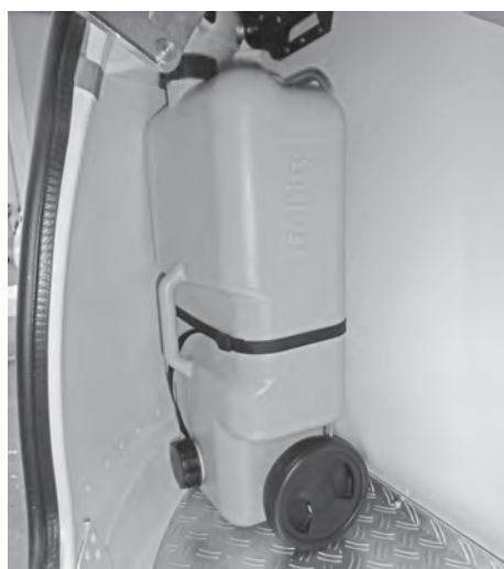
Spildevandstank i gaskasse
