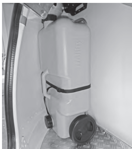
Spildevandstank i gaskasse
